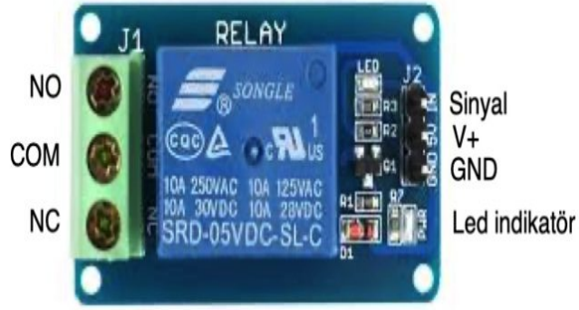
Şekil 3.15. Rölö Kartın Bağlantı Pinleri
