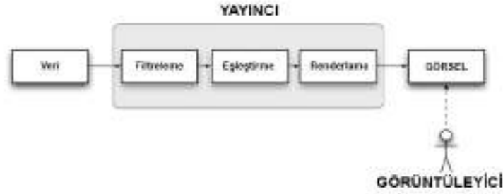
Şekil 2.9 Yayınıcı bir görsel oluşturur, görüntüleyici statik bir görüntüyü analiz eder (Wood ve ark., 1996)
