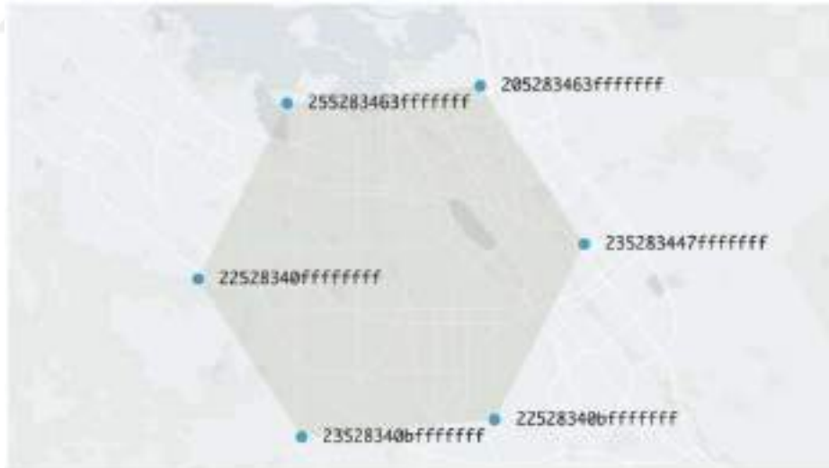
Şekil 3.14 6 Farklı H3 köşe noktası indeksine sahip H3 altıgen hücresi (URL-15)
