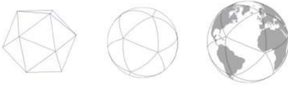
Şekil 3.4 H3'ün harita projeksiyonu için kullandığı yirmiyüzlü yüzey ve yirmiyüzlü yüzeye odaklanan gnomonik projeksiyon (URL-8)
