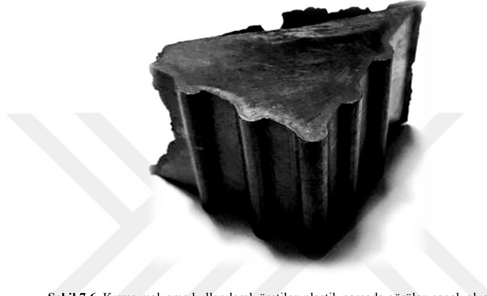
Şekil 7.6. Kırma malzeme kullanılarak üretilen plastik parçada görülen çapak oluşumları.
