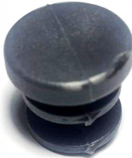
Şekil 7.10. Bir plastik parçada oluşan çökme ve çöküntüler.
