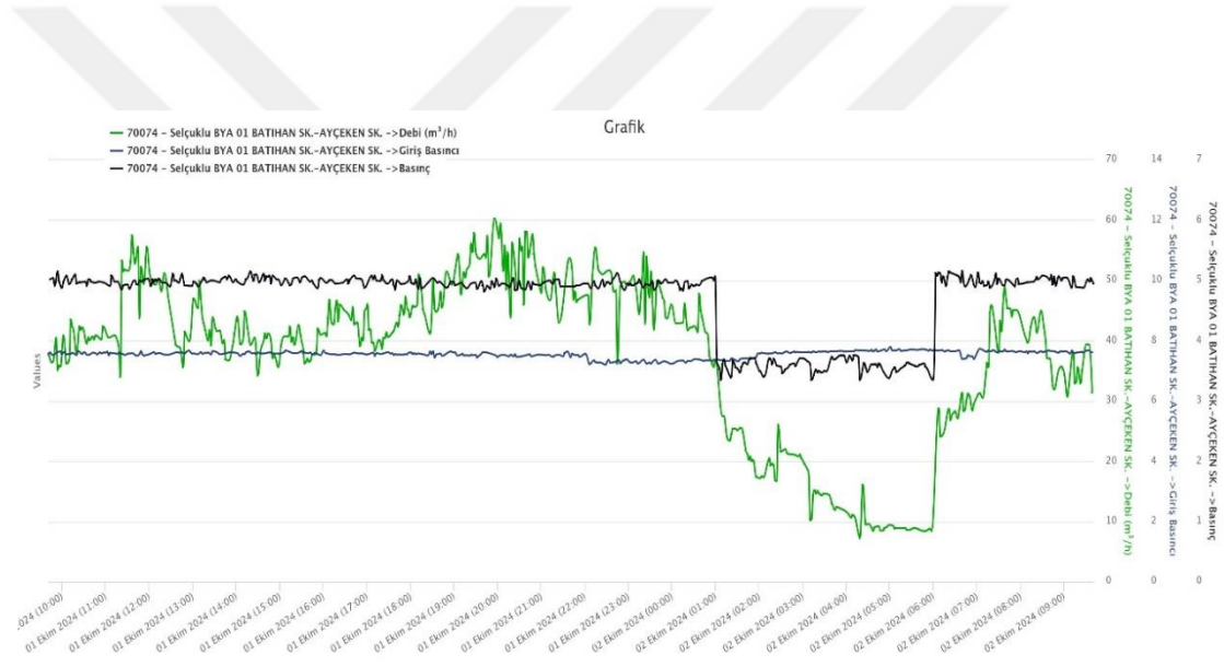
Şekil 3.13. Selçuklu BYA 02 izole bölgesinin anlık debi, giriş ve basınç kırıcı çıkış basınç bilgilerini gösteren örnek SCADA ekranı (KOSKİ, 2024)
