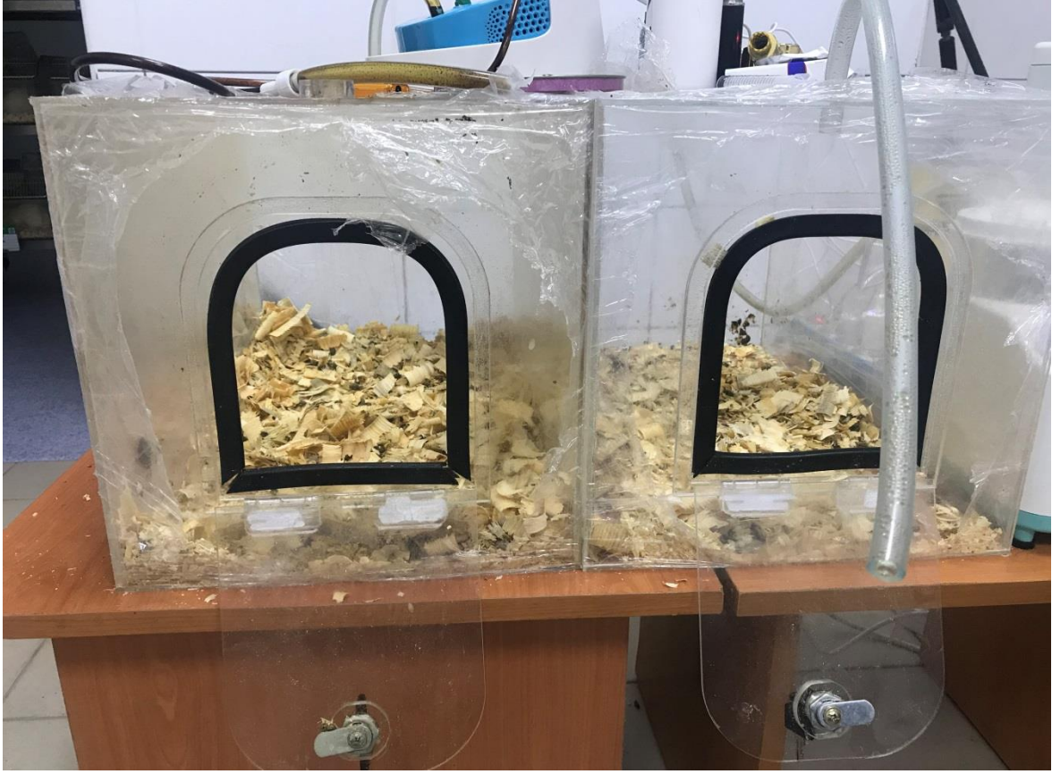
Şekil 3.1 Sıçanların E-sigara Buharı ve Sigara Dumanına Maruz Bırakıldığı Pleksi-glass Kafeslerden Bir Görüntü
