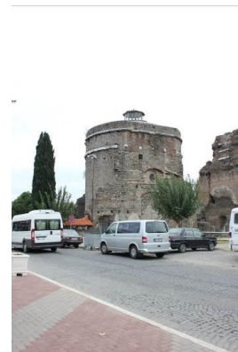
Şekil 2.15. Kireç harç bağlayıcılı, tuğla duvarlı Bergama Kızılavlu, Roma dönemi.
