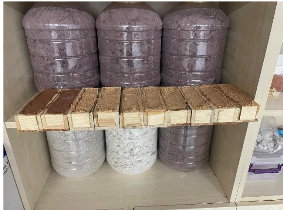
Şekil 4.34. Deney süreci için kalıplara dökülen öneri onarım harçları.
