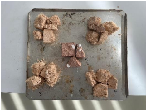
Şekil 4.35. Etüv için hazırlanmış olan öneri onarım harcı örnekleri.
