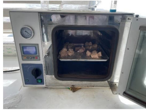
Şekil 4.35. Etüv için hazırlanmış olan öneri onarım harcı örnekleri.
