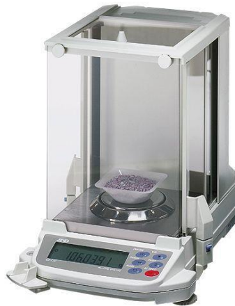
Şekil 3.2. A&D COMPANY N92 model, 0.1 mg hassasiyete sahip analitik terazi.
