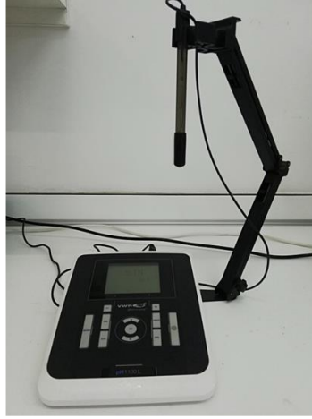
Şekil 3.3. Thermo Orion Model 9206BNWP pH elektrotu ile VWR marka pH-iyon metre.
