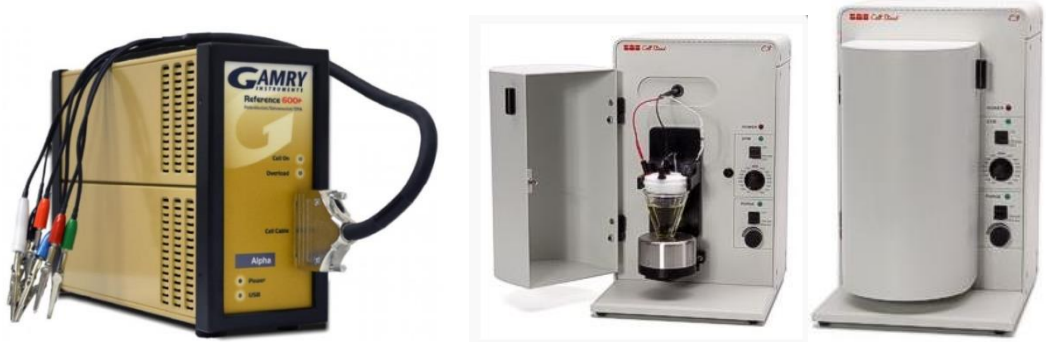
Şekil 3.1. Voltametri ve impedans deneylerinin gerçekleştirildiği GAMRY reference 600+ ve Series 750 elektrokimyasal analizörleri ve C3 hücre sistemi.
