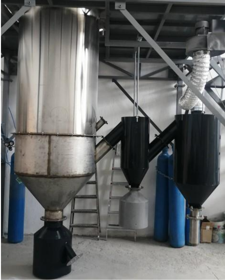
Resim 4.5. Atomizasyon kulesi, siklonlar ve aspiratör.
