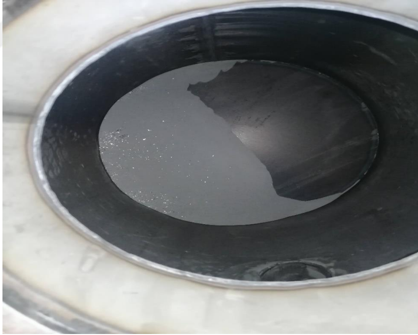
Resim 4.8. Birinci siklon toz toplama ünitesi
