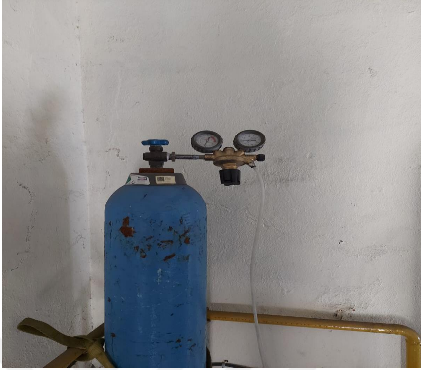
Resim 4.10. 230 bar iç basınca sahip argon tüpü, bağlantı hortumu ve manometre
