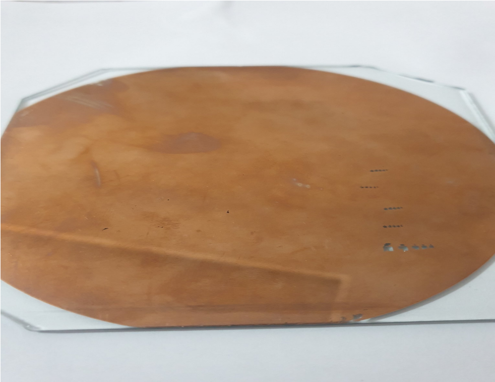
Şekil 2.8. Bakırın lazerle kazınarak oluşturulan maske test yapıları
