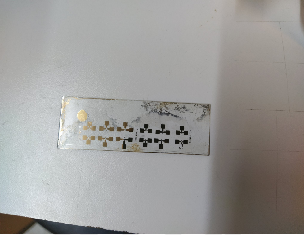
Şekil 3.3. Altın ve alüminyum aşındırılmış örnek
