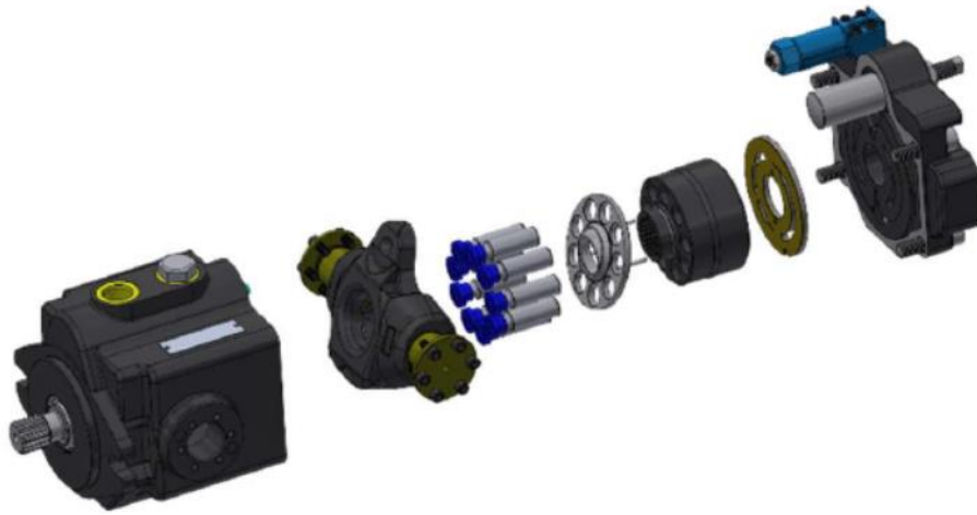
Şekil 2.2. Analiz edilen pompanın patlatılmış görünümü (Frosina ve ark., 2018)
