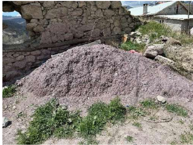
Şekil 4.42. Eflatun renkli çorak
