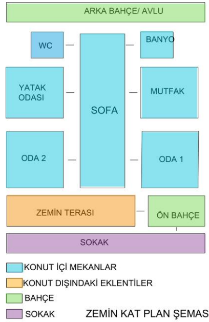
Şekil 4.25. Yılmaz Karakiraz evi zemin kat plan şeması
