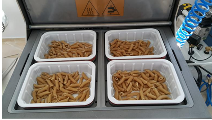
Şekil 3.7. Yaş makarna örneklerinin modifiye atmosferde paketlenmesi
