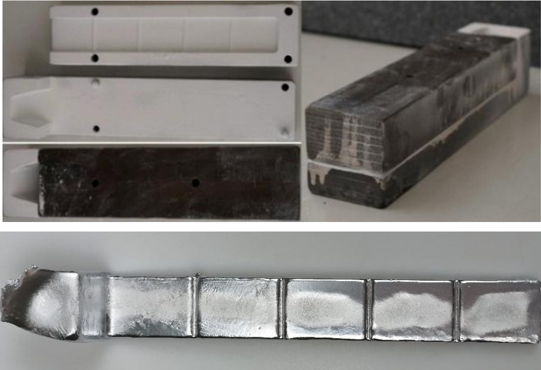
Şekil 3.9. K-mold kalıbı ve örnek numune
