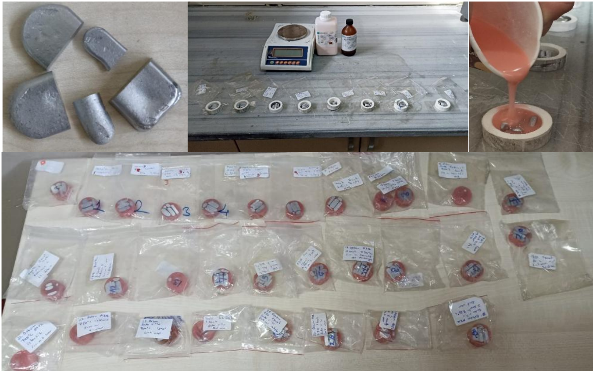
Şekil 3.20. Mikroyapı numuneleri bakalite alınması ve alınan numune görseli
