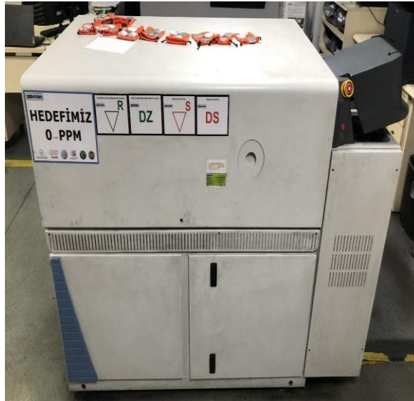
Şekil 3.22. Dency numunelerinin kimyasal bileşiminin belirlendiği spektrometre cihazı görüntüsü.
