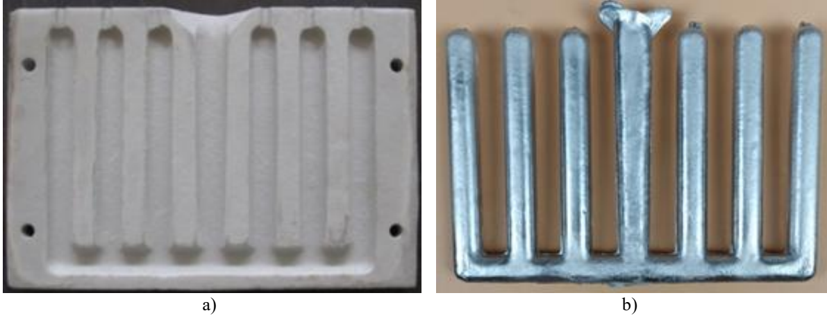
Şekil 3.12. a) Mekanik test kalıbı ve b) mekanik test örnek numune
