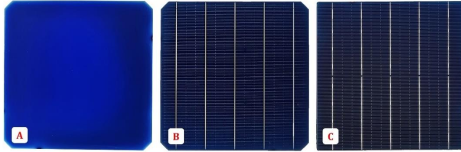
Şekil 5.9. P-tipi Mono PERC M2 güneş hücrelerinde metalizasyon A) Metalizasyon işlemi yapılmamış hücre, B) Ni pasta baskılı hücre C) Ag pasta baskılı referans hücre.
