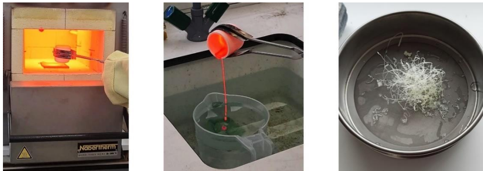
Şekil 4.5. Cam fritlerin üretimi: Eritme ve Hızlı Soğutma (Melt Quenching) tekniği.
