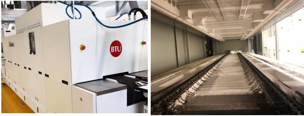
Şekil 4.15. Altı bölge, IR lambalı ısıl işlem fırınının dıştan ve içten fotoğrafları (Asav, 2022).
