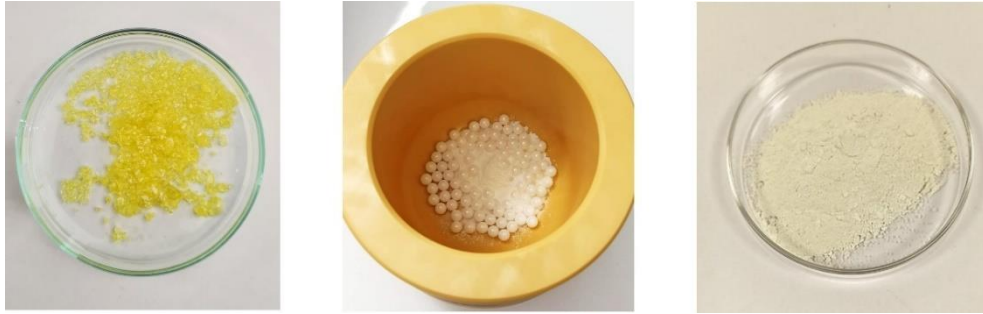
Şekil 4.6. Cam parçacıklarının bilyeli öğütücü ile toz haline getirilmesi. Metal pasta bileşenleri: Cam frit.
