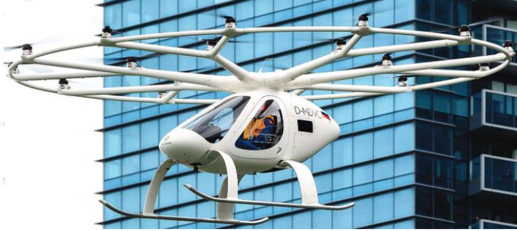
Şekil 1.8. Volocopter hava taksi prototipi (Ong, 2019)
