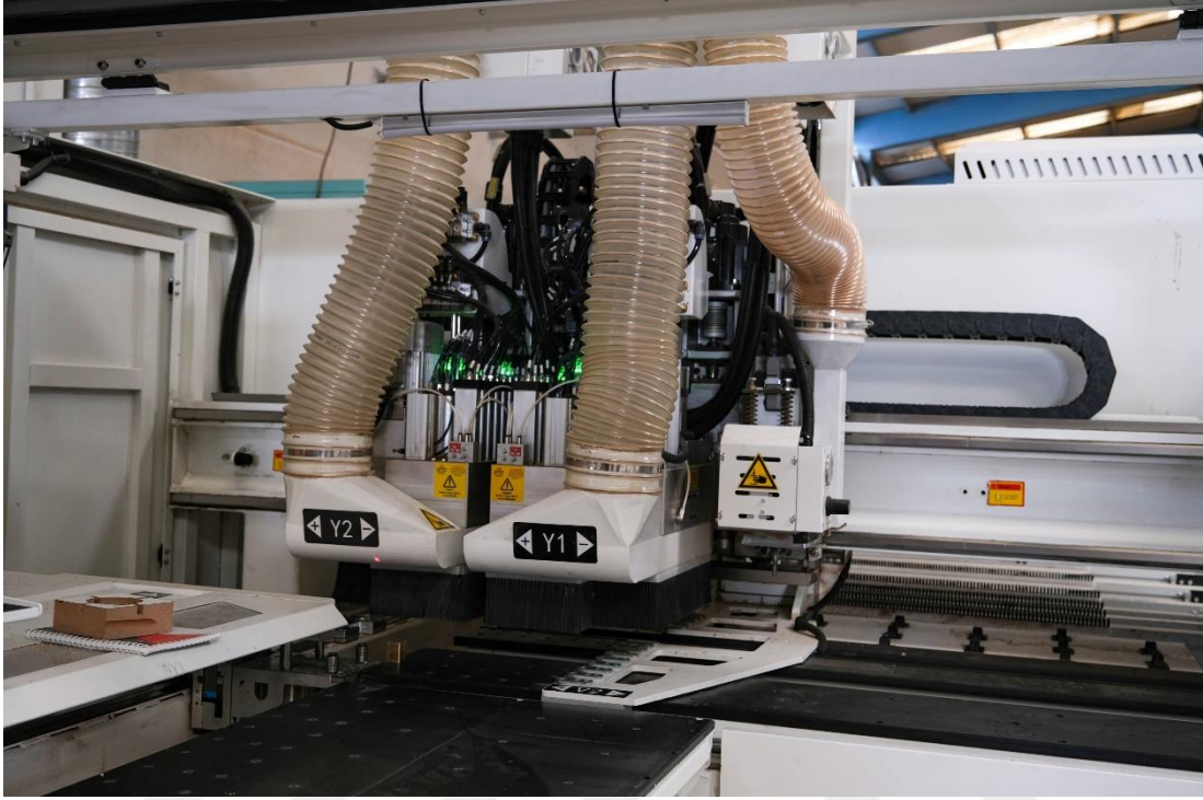
Şekil 2. 13. Sabit donatı imalatında kullanılan CNC kesim makinesi örnek görseli (Kişisel Arşiv)
