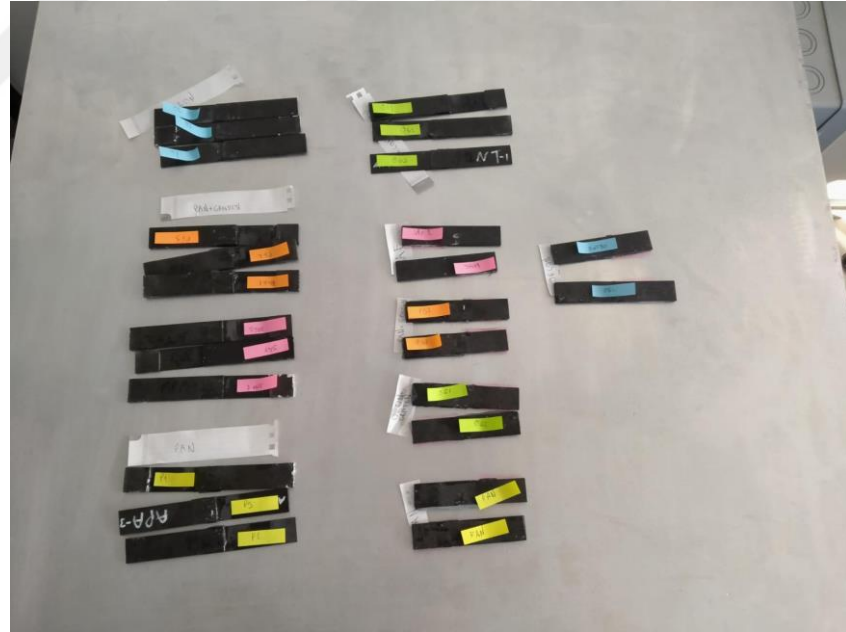
Şekil 3.4. Numunelerin kürleme işlemi için alüminyum ısıtıcı masada bekletilmesi
