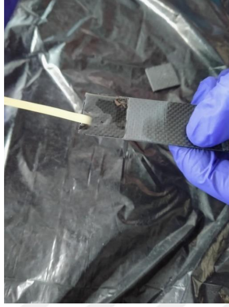
Şekil 3.3. Epoksinin karbon fiber kompozitin bağlantı noktasına uygulanması
