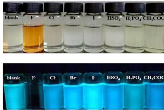
Şekil 2.10. F^- anyonu varlığında günışığı ve 365 nm UV ışığı altında sensörde gözlenen değişim
