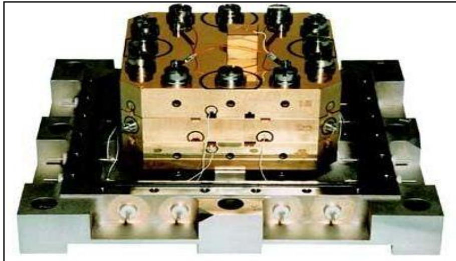
Şekil 2.3. STAR ivme ölçer. (GFZ, 2017)
