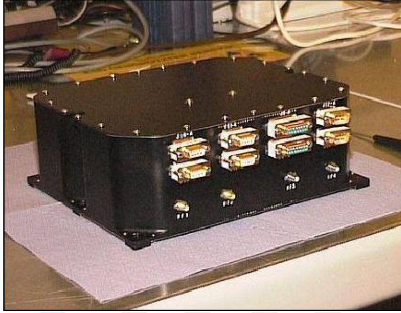
Şekil 2.2. BlackJack GPS alıcısı (GFZ, 2017)
