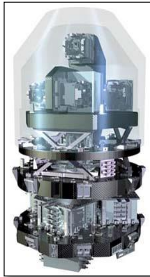
Şekil 2.15. GOCE uydu gradyometresi (DLR, 2018)
