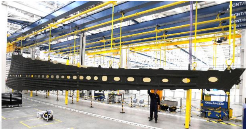
Şekil 2. Uçak Kanadında Kullanılan Pekiştirilmiş Panel (B. Li vd., 2022)
