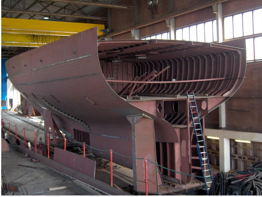
Şekil 4. Gemi Gövdesinde Kullanılan Pekiştirilmiş Panel (Graafship | Construction in Steel and Aluminium - shop15320.tinerahbek.com, y.y.)
