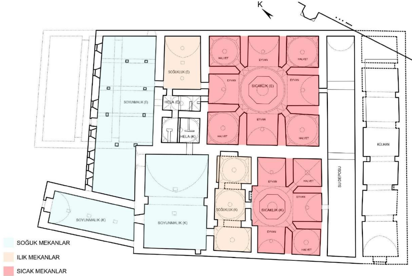
Şekil 2.5. 13.yy (1238) Haçvari Dört Eyvanlı ve Köşe Hücreli Tip Plan Şemasına Sahip Kayseri Huand (Hatun) Hamamı. * Yılmaz Önge'nin (1995) kitabından alıntılanarak yazar tarafından yeniden çizilmiştir.
