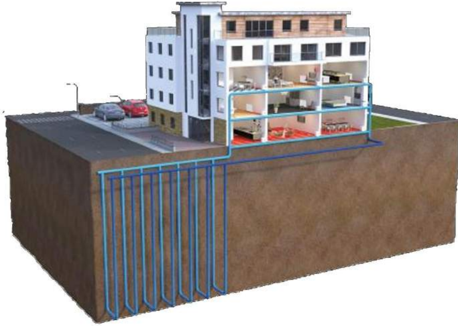
Şekil 4.10. Düşey tip döşenmiş toprak kaynaklı ısı pompası şematik çizimi (URL – 22).
