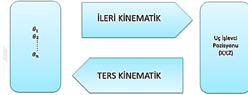
Şekil 3.2 ileri ve ters kinematik arasındaki ilişki.
