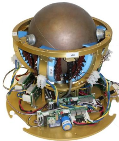
Şekil 3.8 Küresel indüksiyon motoru (Seyfarth, Bhatia ve ark. 2016).
