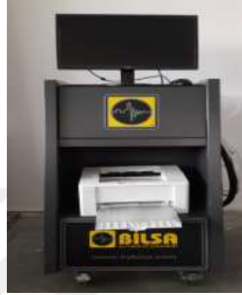
Şekil 3.14. BİLSA MOD 2210 Marka Egzoz Emisyon Cihazı
