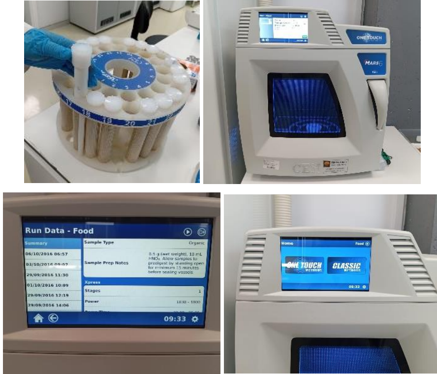
Şekil 3.15. Mineral analizi ve MARS 6 cihazı.
