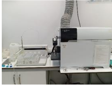
Şekil 3.16. İndüktif eşleşmiş plazma kütle spektrometresi (Agilent Technologies- 7900 ICP-MS / ASX 500).
