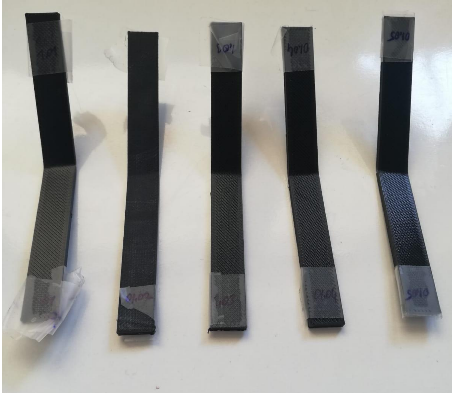
Şekil Ek 1.2: 1 numaralı numune grubunun test sonrası durumu
