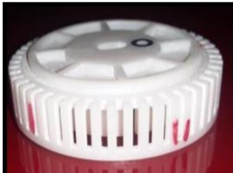
Şekil 2.10: SLA yöntemi ile üretilmiş bir parçanın görünümü (Choudhari ve ark., 2016)
