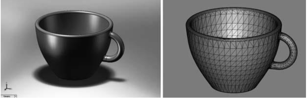
Şekil 2.2: CAD modeli (solda) ve STL formatına dönüşmüş hali (sağda) (GIBSON, Ian, et al.2014)
