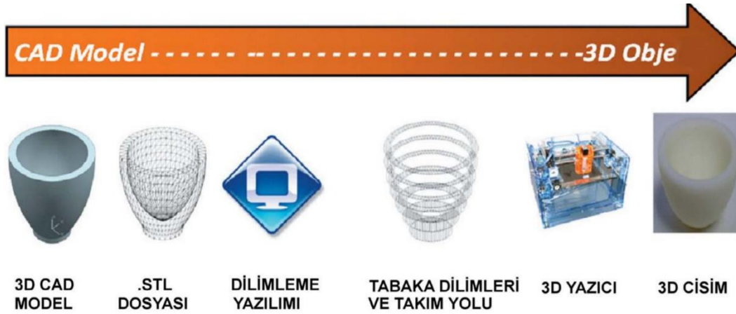
Şekil 1.1: Genelleştirilmiş eklemeli imalat süreci (Kara. N., 2013)
