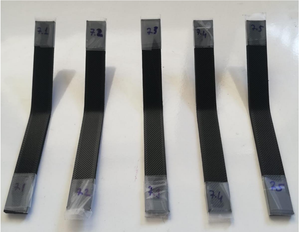
Şekil Ek 1.8: 7 numaralı numune grubunun test sonrası durumu
