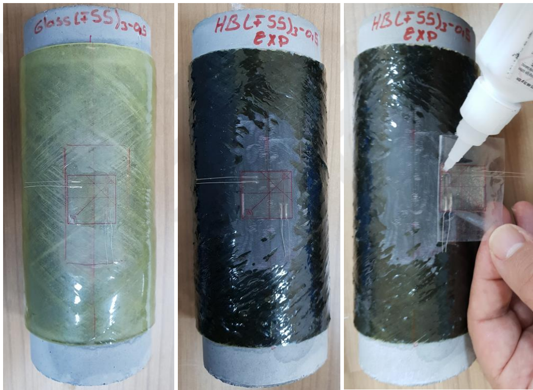
Şekil 4.6. Gerinim ölçer uygulanan kompozit borular
