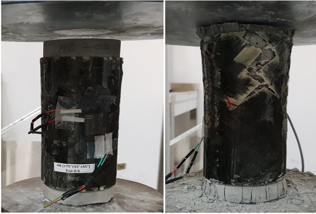
Şekil 5.22. ( \pm 75^\circ/\pm 55^\circ/\pm 45^\circ ) hibrid kompozit boruda-0,5 oluşan hasar (deney öncesi-sonrası)
