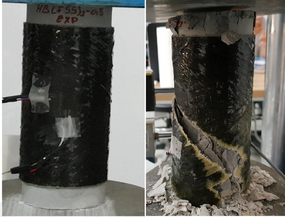
Şekil 5.13. (\pm 55^\circ)_3 hibrid kompozit boruda-0,5 oluşan hasar (deney öncesi-sonrası)
