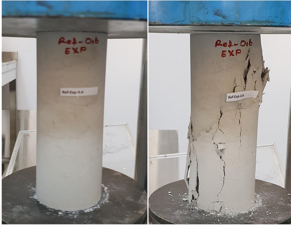
Şekil 5.32. Referans-0,6 numunede oluşan hasar (deney öncesi-sonrası)
