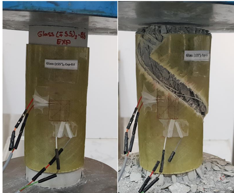
Şekil 5.8. (\pm 55^\circ)_3 GFRP-0,6 numunesinde oluşan hasar (deney öncesi-sonrası)
