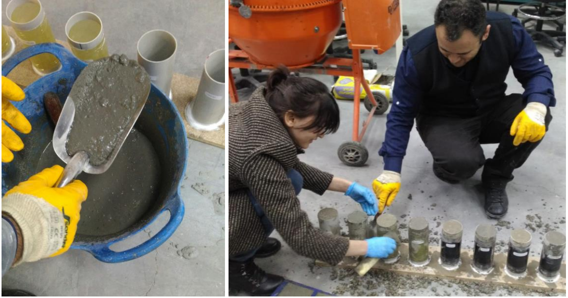
Şekil 4.4. Genleşen çimentolu beton uygulaması
