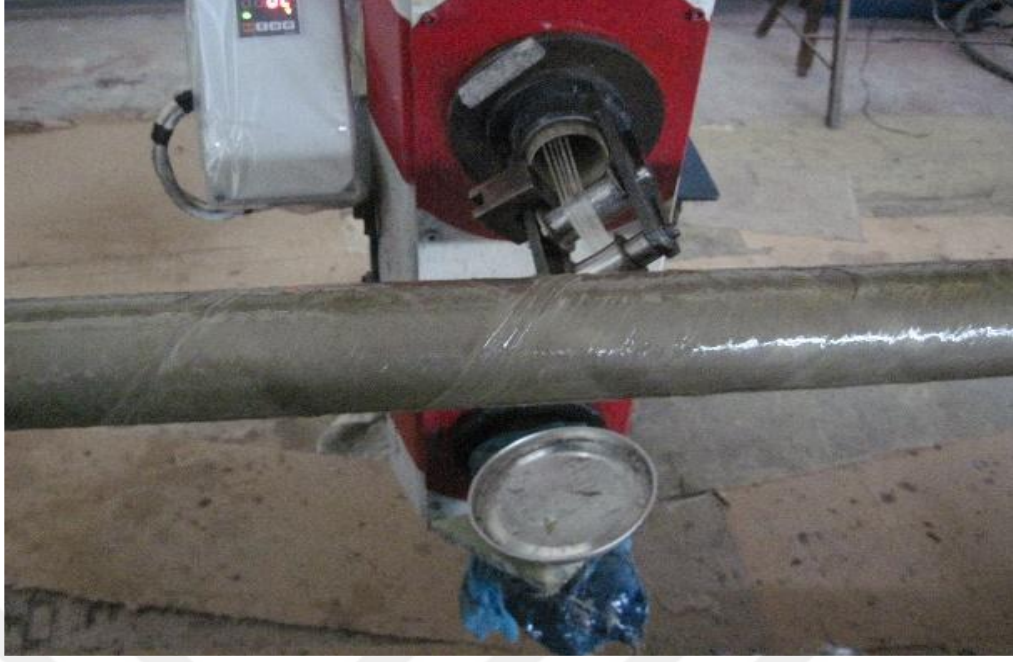
Şekil 3.3. Kompozit boruların filaman sarım tezgahında üretimi (Gemi ve ark., 2018)
