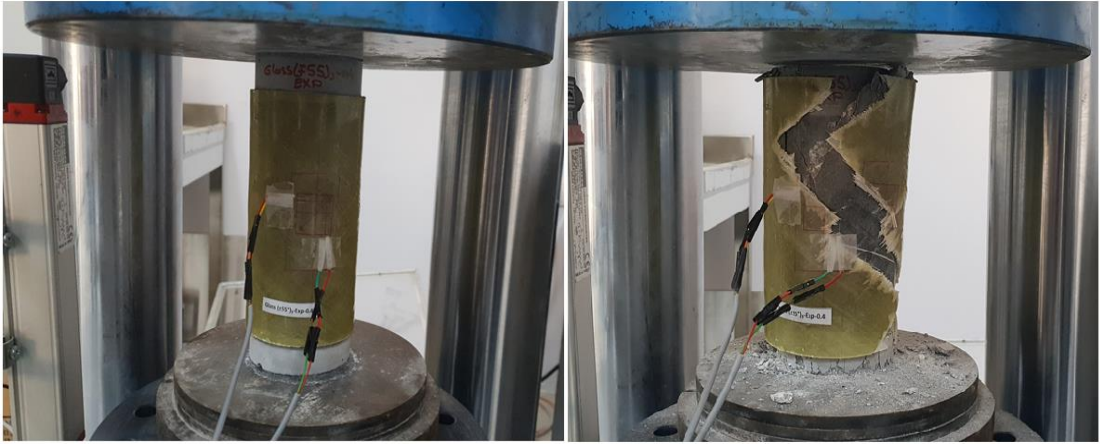
Şekil 5.2. ( \pm 55^\circ ) 3 GFRP-0,4 numunesinde oluşan hasar (deney öncesi-sonrası)
