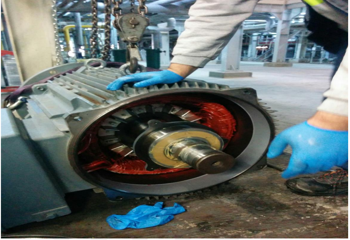
Şekil 5.3. Rulmanı değiştirilmiş bakım aşamasına alınan motor
