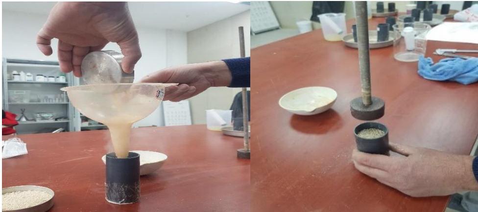
Şekil 4.4. Zeminin kalıba uygun sıklık derecesinde yerleştirilme aşaması
