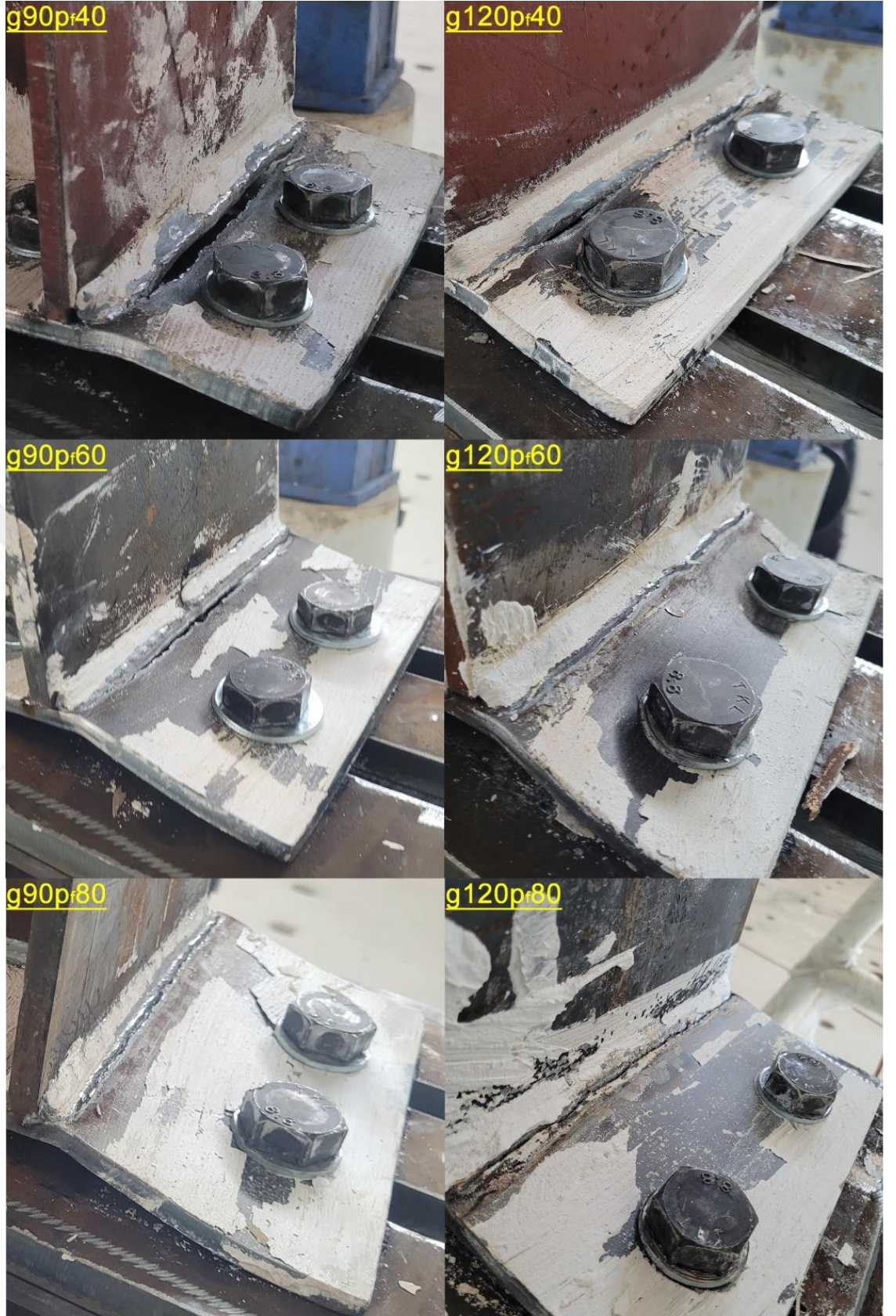
Şekil 5.5.1. Rijitlik levhasız uzatılmış alın levhalı numunelerin göçme modları
