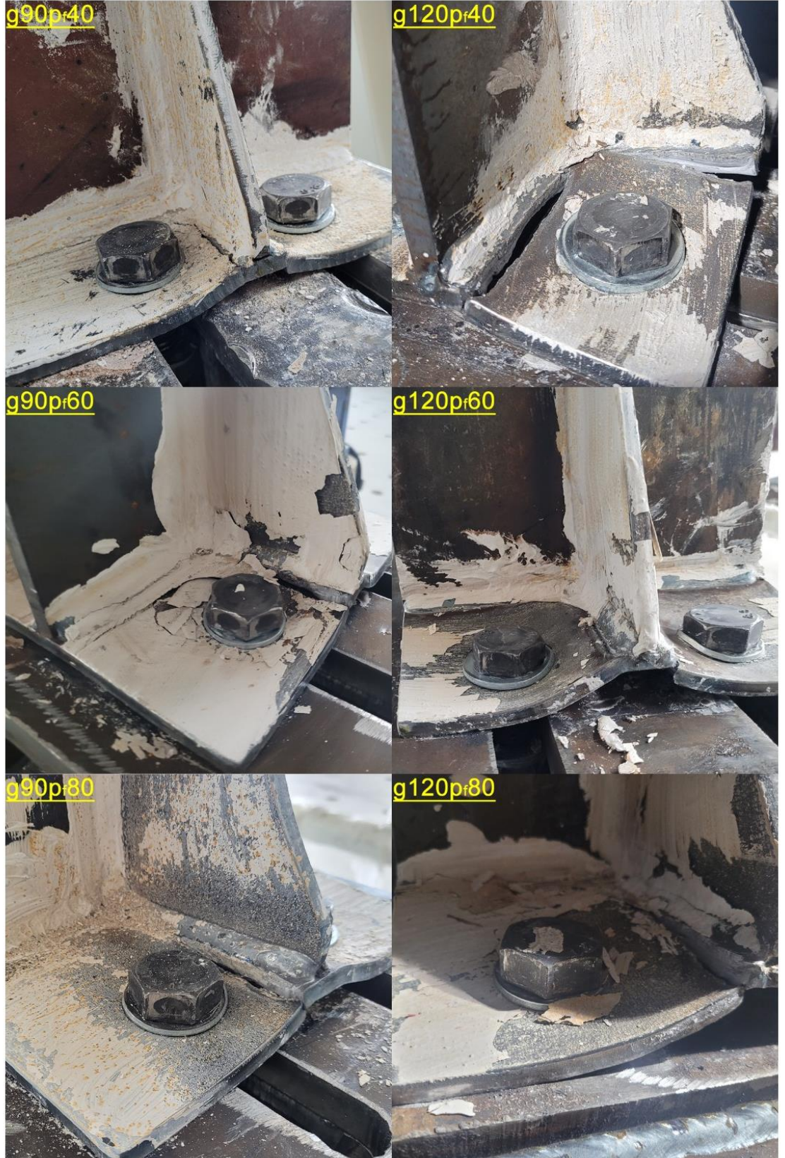
Şekil 5.5.2. Rijitlik levhalı uzatılmış alümin levhalı numunelerin göçme modları
