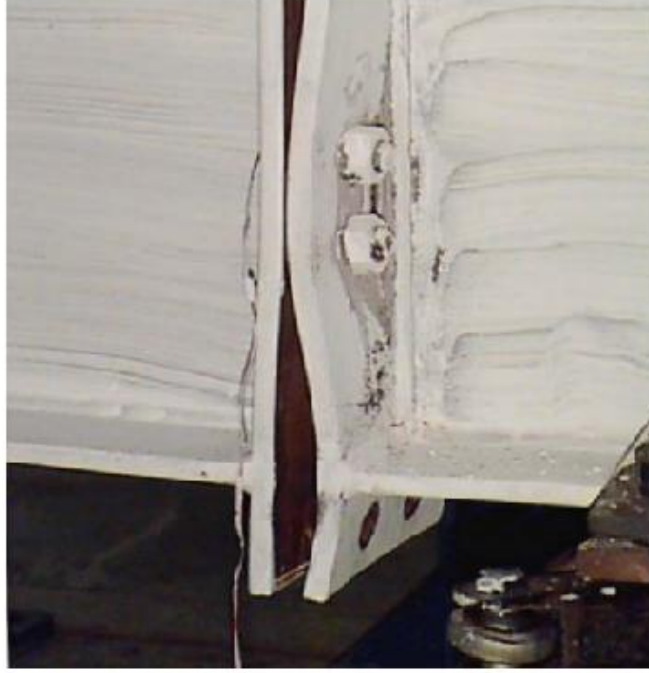
Alın levha plastik deformasyonu (Emmett A. Sumner, 2003)
