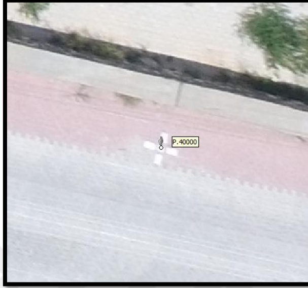
Şekil 5.12. Yazılım tarafından otomatik olarak görüntü üzerinde yaklaşık yerine gelen YKN noktası
