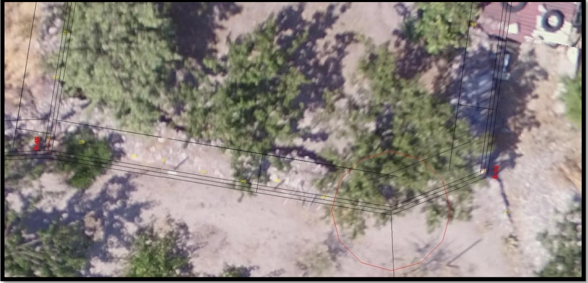
Şekil 5.26. Ağaçların sınır noktalarının ölçümüne etkisi
