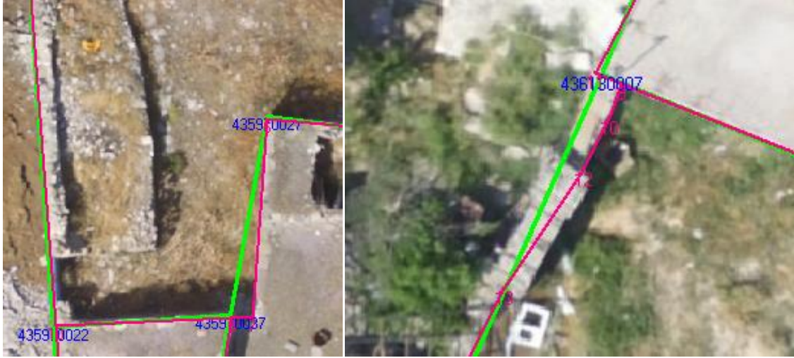
Şekil 5.23. Arazi şartları sebebiyle ya da operatör kaynaklı doğru okunmayan sınır noktaları
