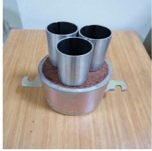
Şekil 3.21. Tüplerin kalıba çakılması
