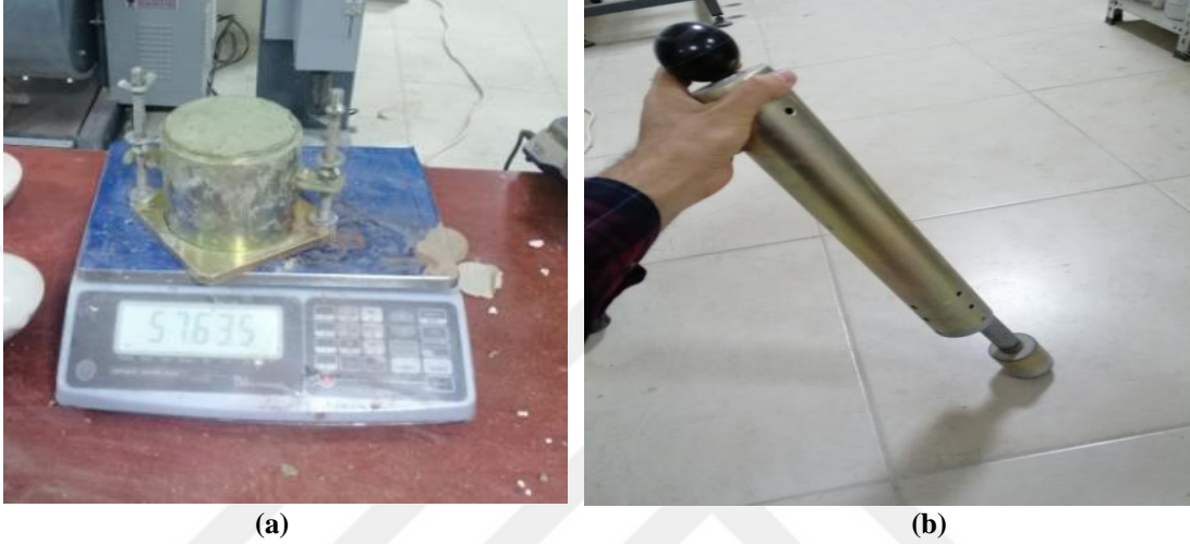
řekil 3.15. (a) Standart proktor kalıbı (b) Kompaksiyon iřleminde kullanılan tokmak (2.5 kg)
