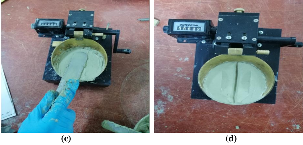
Şekil 3.12. (a)-(b)-(c)-(d): Casagrande Deneyi ile likit limitin belirlenmesi
