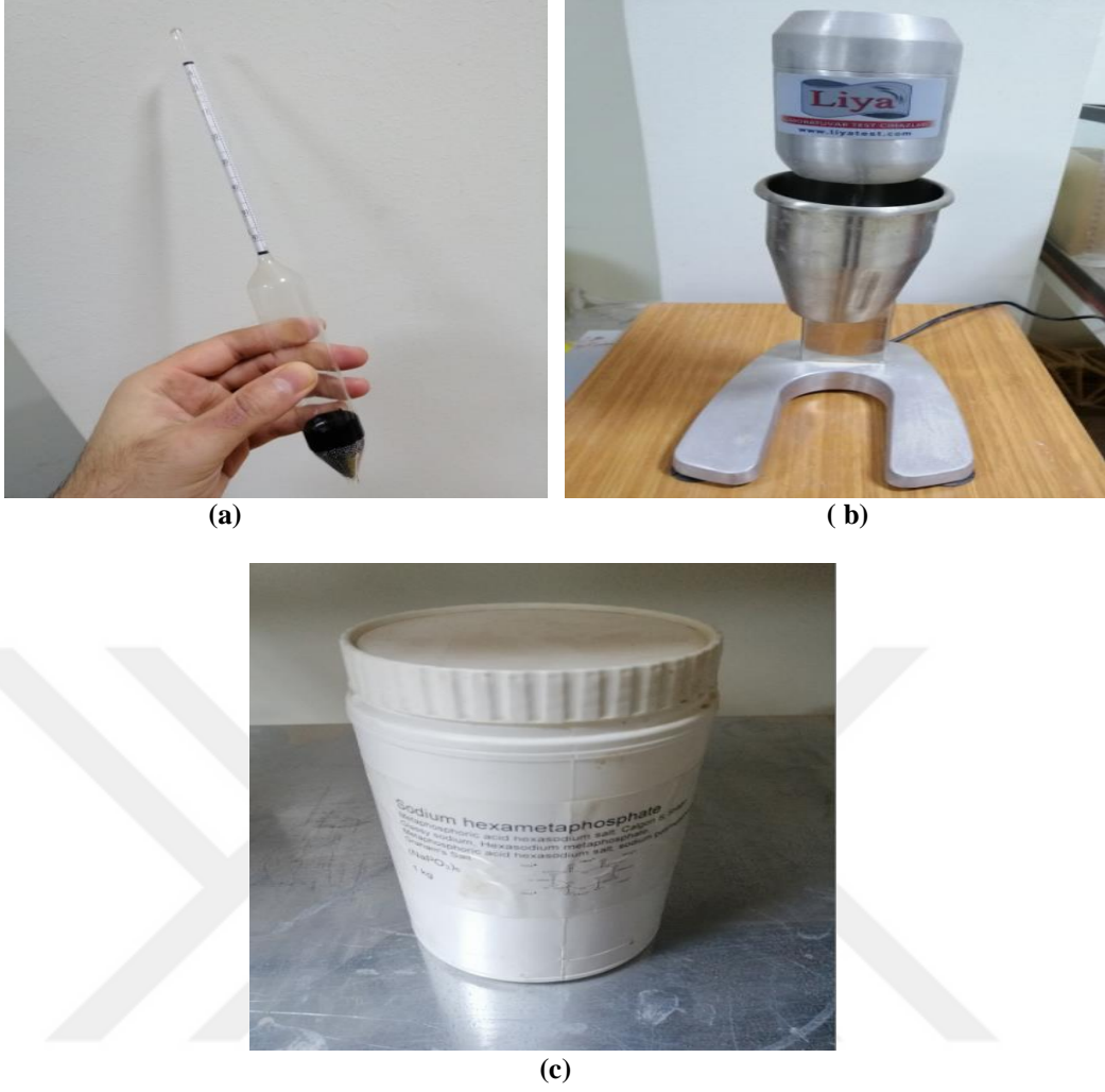
Şekil 3.9. (a) Hidrometre aleti (b) Yüksek devirli karıştırıcı (c) Ayrıştırıcı kimyasal madde(Soydum heksametafosfat)
