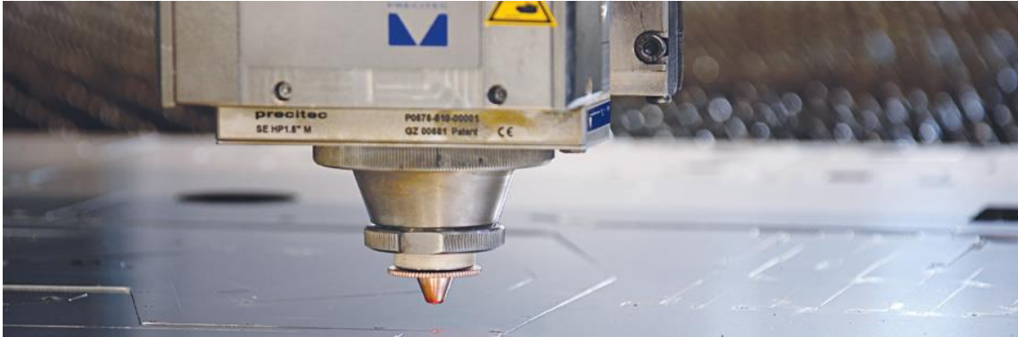
Şekil 1.3. Lazer kesimde kapasitif mesafe kontrolü
