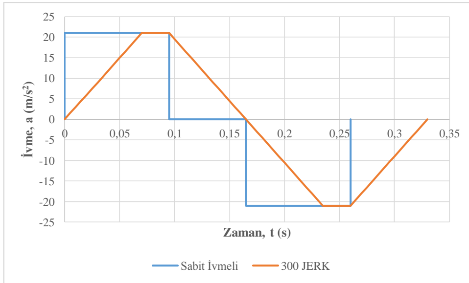
Şekil 3.7. Sabit ivmeli hareket ve 300 jerk ile kontrol edilen hareket karşılaştırmalı ivme - zaman grafiği
