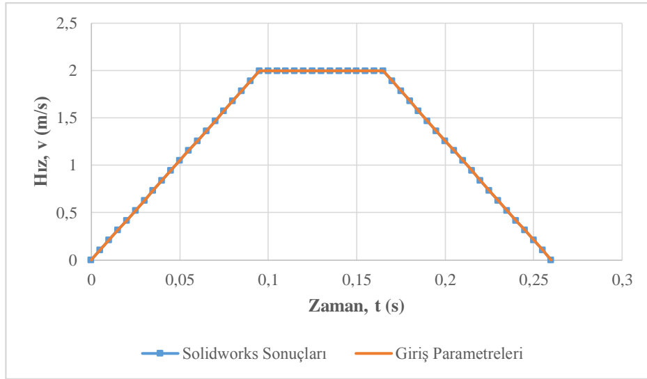
Şekil 3.3. Sayısal dinamik analiz sonucu ile analiz girdi hız değerlerinin kıyaslanması
