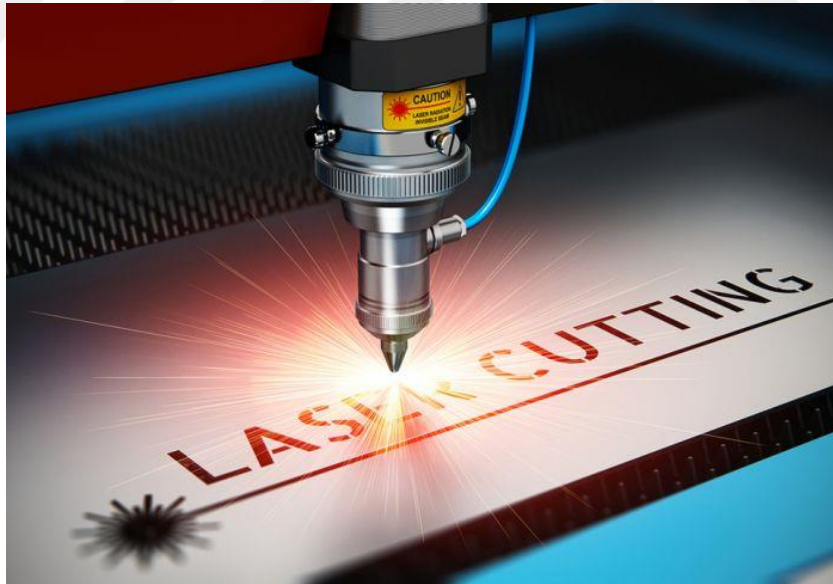
Şekil 1.1. Lazer başlığı ile lazer kesim işlemi
