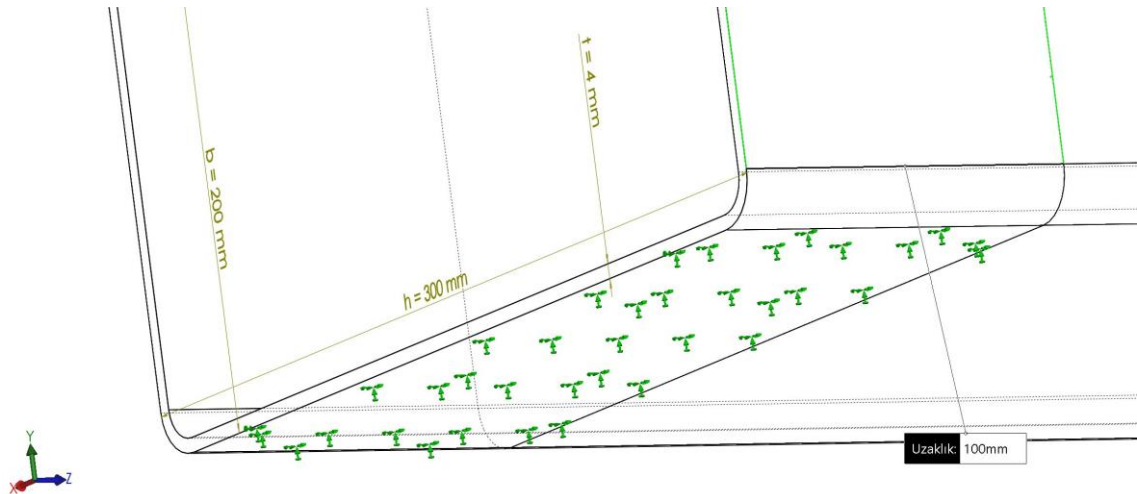
Şekil 4.9. Sayısal statik analiz ikinci fikstür durumunun gösterimi
