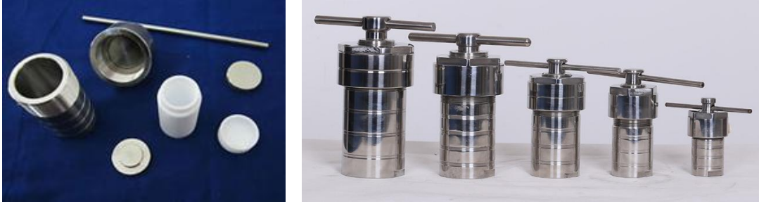
Şekil 3.2 Teflon cidarlı otoklav ve ebatları
