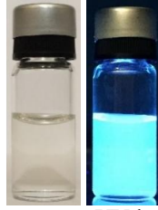
Şekil 3.14 CQD-5'in gün ışığı ve UV lamba altındaki fotoğrafları
