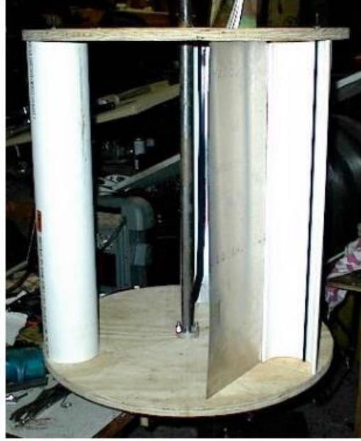
Şekil 2.9. Gohil ve arkadaşlarının tasarlayıp ürettikleri Lenz tipi DERT
