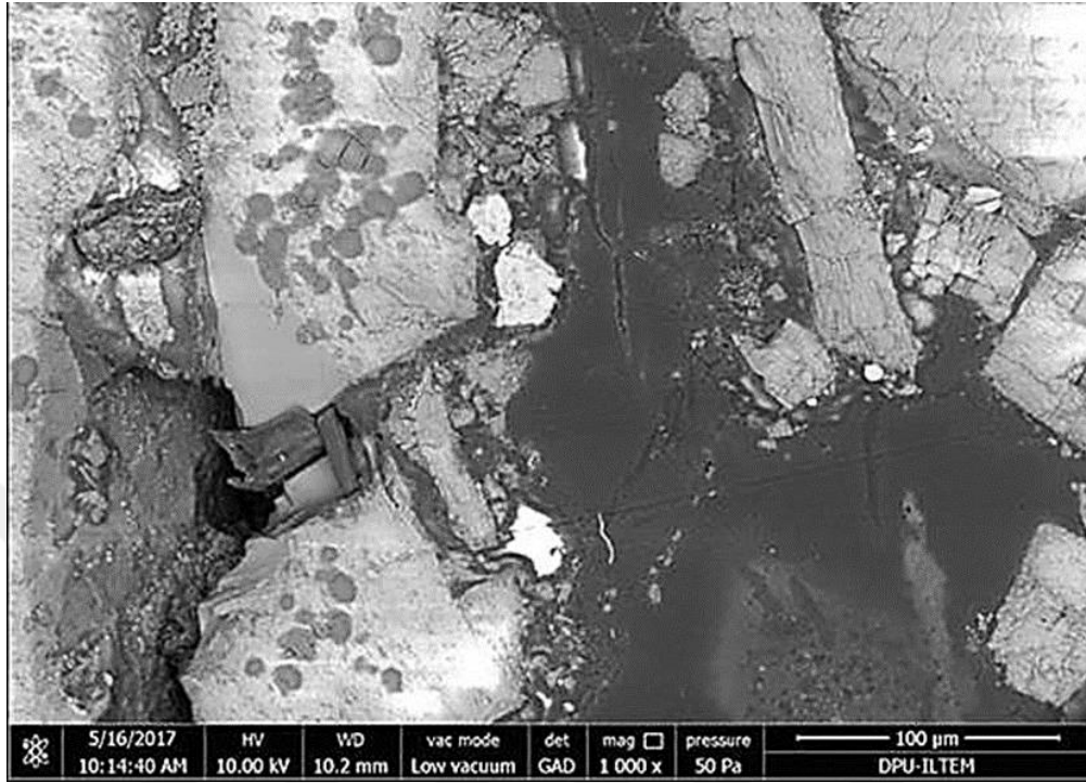
Şekil 4.36. K3 refrakter malzemesinin geri yansıyan elektron görüntüsü (1000×)
