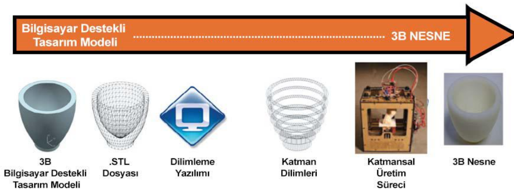
Şekil 4: Katmansal Üretim Süreci
