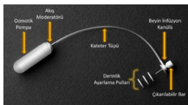
Resim 3.1. Ozmotik pompanın yapısı ve yerleŝtirilme koordinatları.
