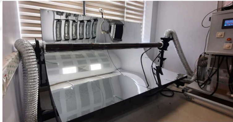
Şekil 3.1. Parabolik oluklu hava kollektörü
