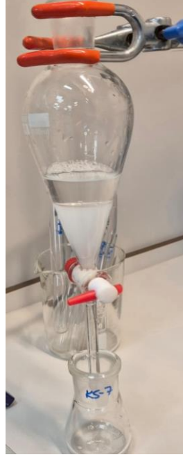
Şekil 6. Sütün yağ fazını ayırmak için n-hekzan ile muamele işlemi
