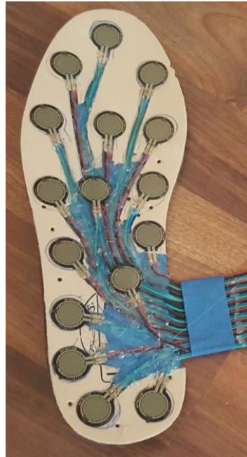
Şekil 5.1. Sensör ve kabloların yerleşimi
