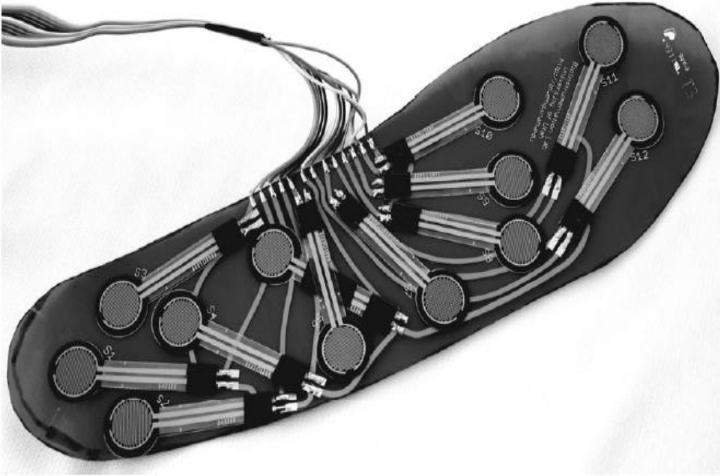
Şekil 2.7. 12 FSR (kuvvet sensörü) den oluşan kinetik analiz çözümü
