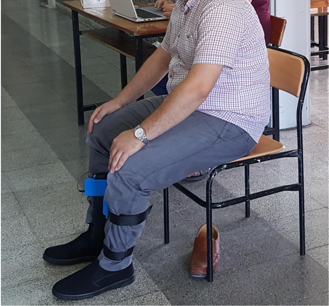
Şekil 3.44. Sistemin hastanın ayağına sabitlenmesi
