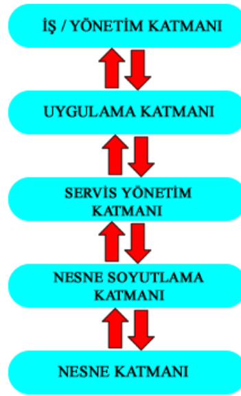
Şekil 2.13. Beş katmanlı mimari model
