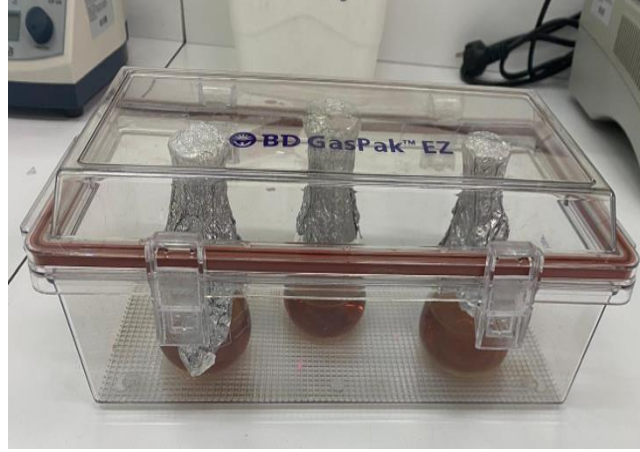
Şekil 3. Probiyotik bakterilerin anaerobik koşullarda büyütülmesi
