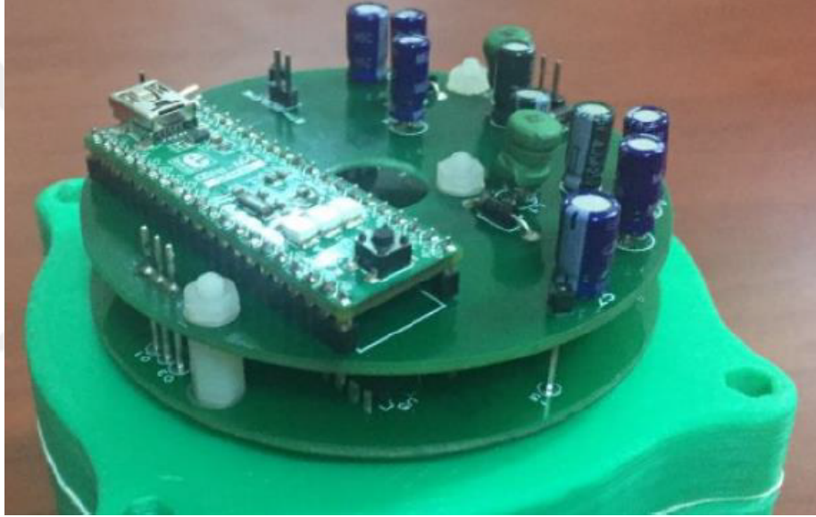
Şekil 5.1. Kapasitif Rotary Enkoder Elektronik Devresi
