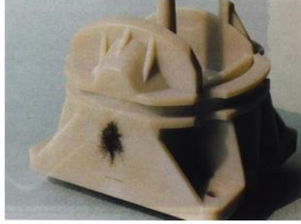
Şekil 3.9. PA Malzemedeki Yanık İzi (Pınar, 2010)
