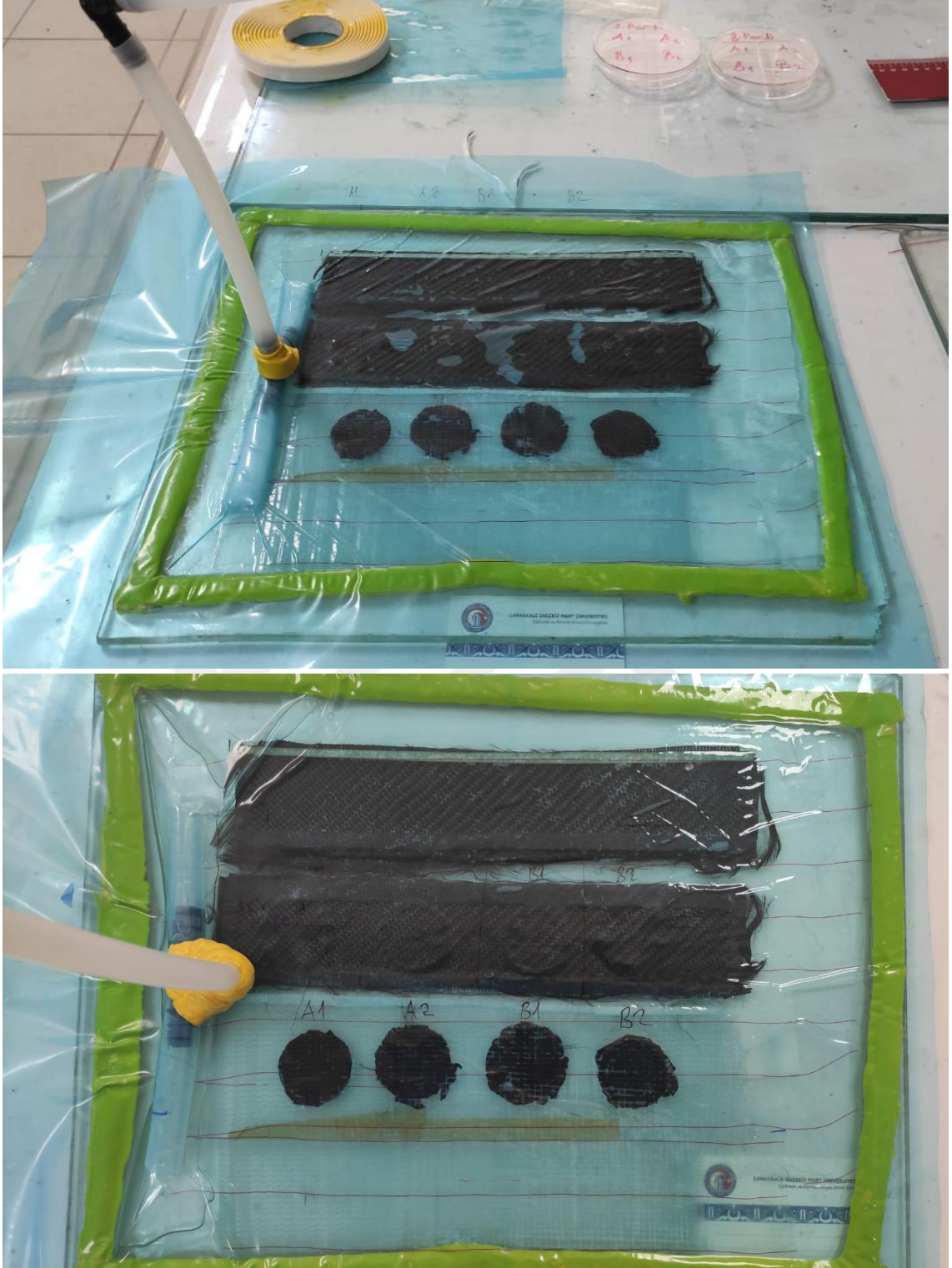
Şekil 3.11. Vakum infüzyon yöntemi ile karbon fiber ve cam elyaf takviyeli kompozit üretimi
