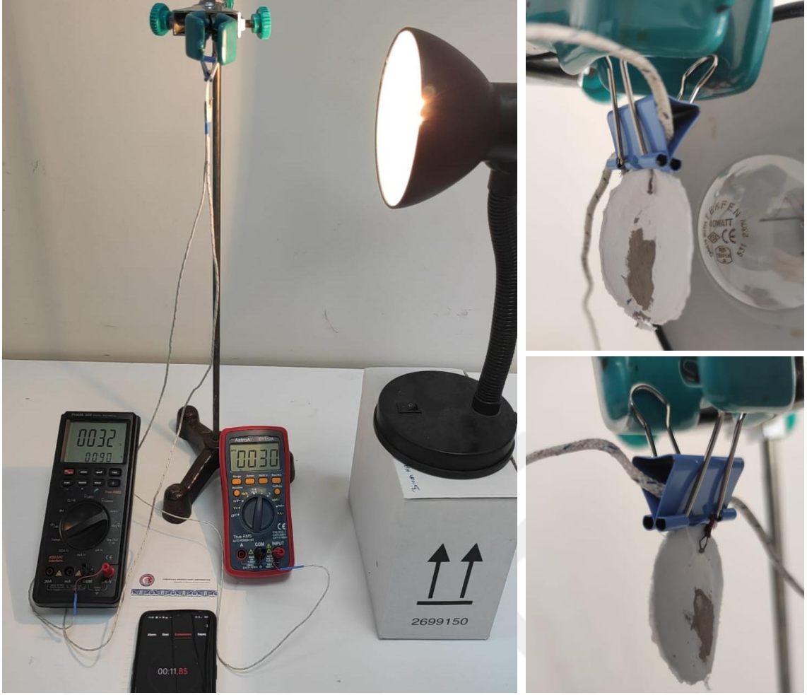
Şekil 3.20. Saf selüloz ve BN katkılı selüloz filmlerin termal iletkenlik ölçümü deney seti
