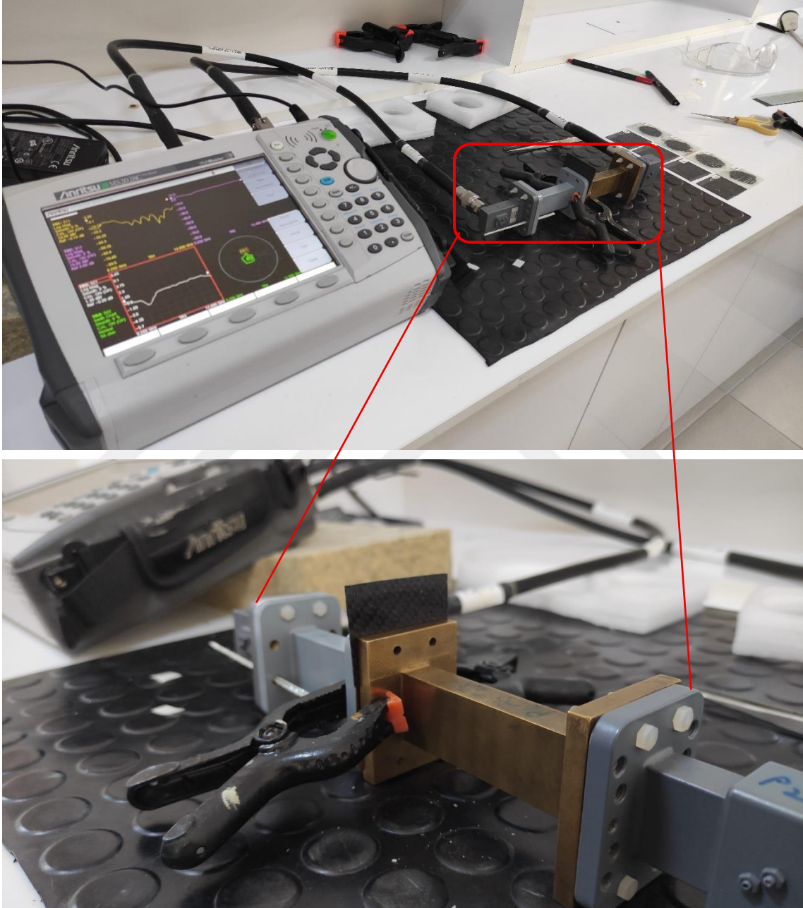
Şekil 3.19. CNT-BN-CNT hibrit ara tabakalı karbon fiber ve cam fiber takviyeli polimer kompozitlerin elektromanyetik koruyucu etkinliklerinin ölçümü
