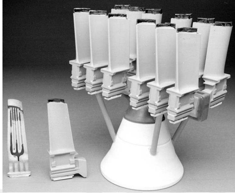
Şekil 2.2. Hassas dökümle üretilen içi boşluklu gaz türbini kanatları
