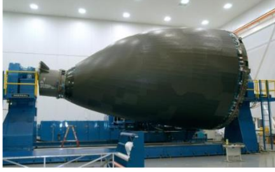
Şekil 30. Üretimi AFP ile Gerçekleştirilen Uçak Radomu (Chen vd., 2023)
