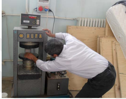
Şekil 3.8. Alınan Beton Örneğinin Dayanıklılığının Tespiti (Köken., A. Arşivi)
