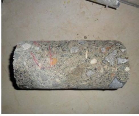
Şekil 3.7. Alınan Beton Örneği (Köken., A. Arşivi)
