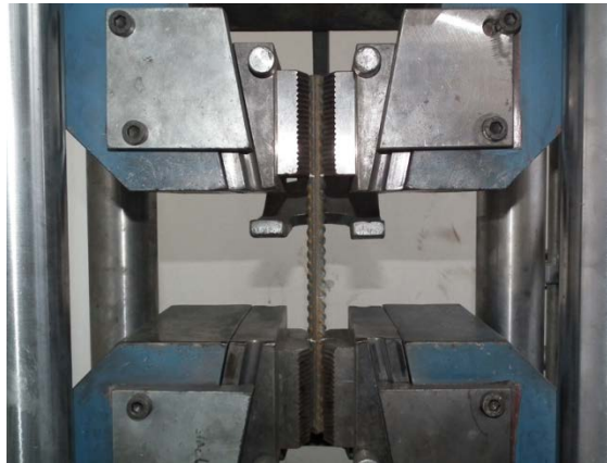
Şekil 3.9. Çekme Testi ile Donatı Özelliklerinin Belirlenmesi (Web İletisi 2)
