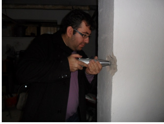
Şekil 3.5. Schmidt Darbe Çekici ile Beton Yüzeyinin Sertliğinin Tespiti (Köken., A. Arşivi)
