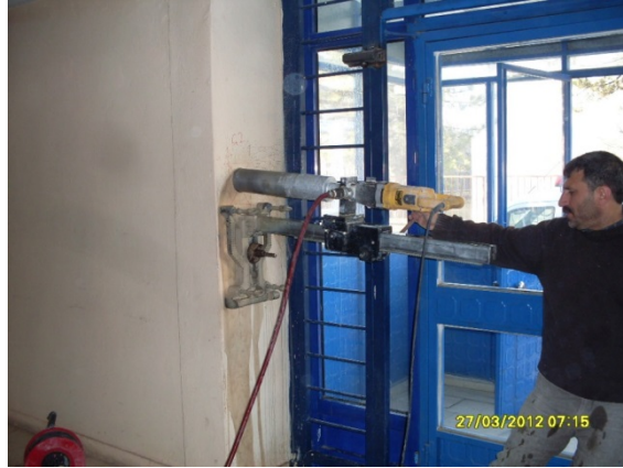
Şekil 3.6. Karot Alma Cihazı ile Silindir Beton Örneği Alınması (Köken., A. Arşivi)
