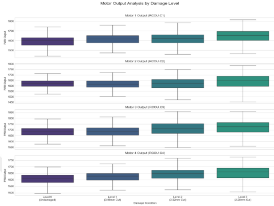
Şekil 3.37. Hasar seviyelerine göre motor çıkışları
