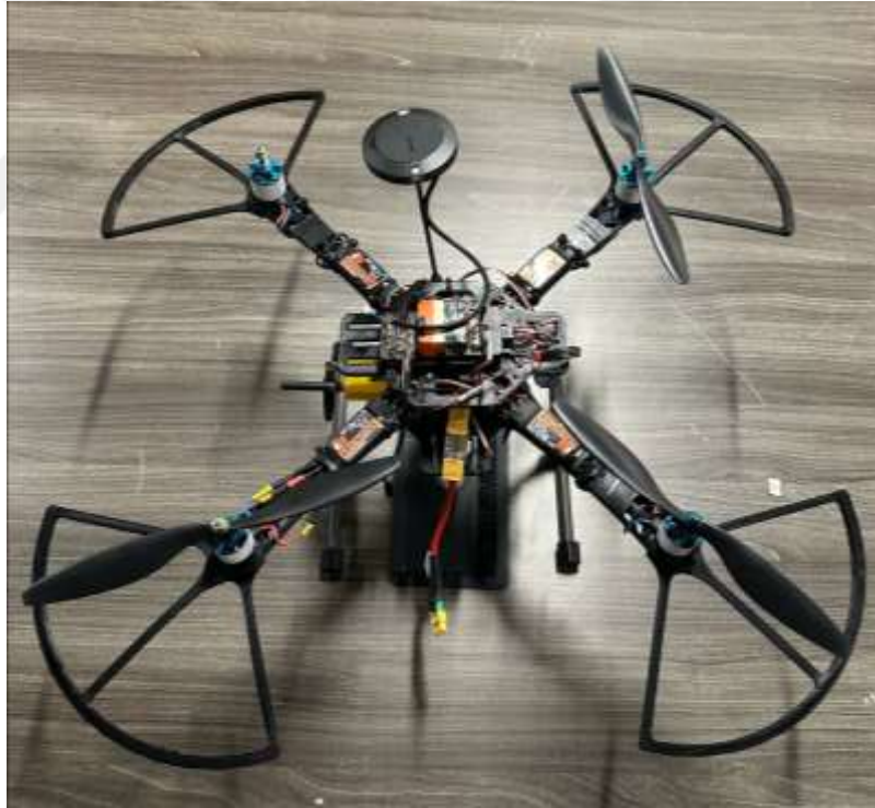
Şekil 2.1. Çalışmada kullanılan 550 mm quadcopter İHA platformu. İHA, Sunnysky X2216-10KV motorlar ve 10 inç kompozit pervaneler ile donatılmıştır. Cube Orange uçuş kontrolcüsü merkezi konumda yerleştirilmiştir.
