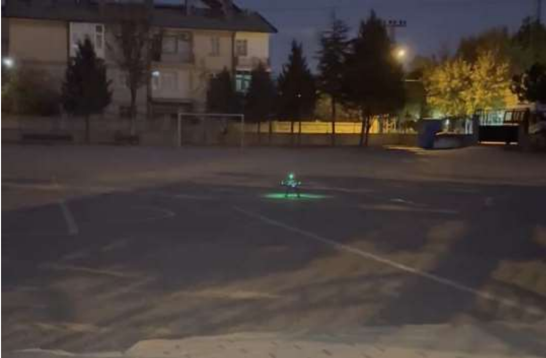
Şekil 2.2. Konya'da bir yükseköğretim kurumu kampüs bahçesinde gerçekleştirilen uçuş testlerinden bir görünüm. İHA, otonom mod (Auto) kullanılarak önceden tanımlanmış GPS waypoint'lerini takip etmektedir.
