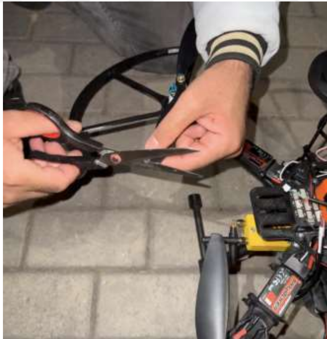
Şekil 2.3. Pervaneye kontrollü hasar verme işlemi. Kesim miktarı dijital kumpas ile hassas şekilde ölçülmüştür.
