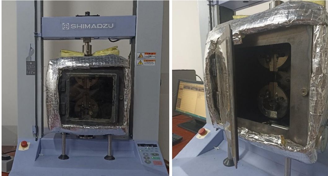
řekil 3.14. Isıtma haznesi tasarımı ve ekme test cihazına yerleřtirilmesi
